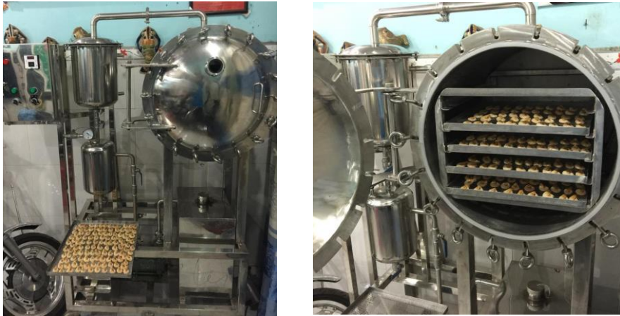
Hình 3: Thiết bị sấy chân không nghiên cứu thực nghiệm
